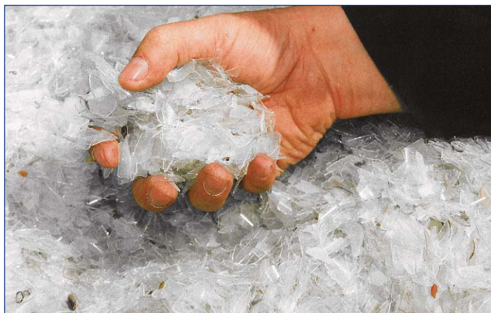
Depois de passar pelo Reciclador MPC4000 da Balcan, o vidro moído limpo não fica tão cortante e pode ser manuseado com cuidado.
