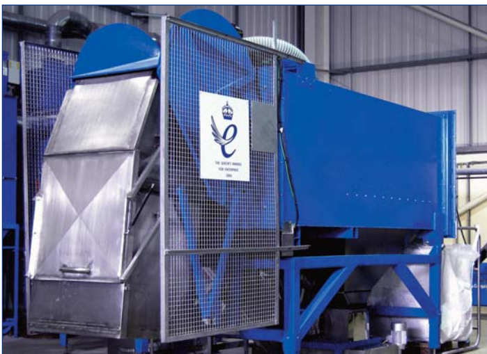
O reciclador é carregado por meio do carregador de aço inoxidável operado hidráulicamente montado na parte frontal, que aceita tambores de 210 litros ou fragmentos soltos. Esta fotografia foi tirada em condições de utilização real na Balcan.
