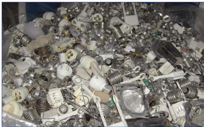
Exemplos do tipo e da condição dos fragmentos de metal e de plástico separados do vidro das lâmpadas.
