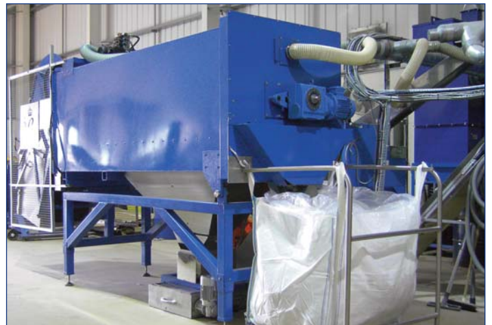
Aqui é exibida a outra extremidade de um dos dois separadores, de onde os componentes de metal e de plástico são descarregados e coletados. Dois deles são usados em paralelo.
