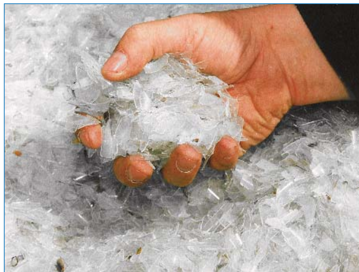
Po przejściu przez maszynę MPC4000 oczyszczona stłuczka szklana nie jest już bardzo ostra, można więc poddawać ją dalszej obróbce przy zachowaniu odpowiednich środków ostrożności.
