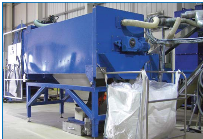
Na fotografii widoczny jest drugi koniec jednego z dwóch separatorów, gdzie zbierane są odpady metalowe i odpady z tworzyw sztucznych. Dwa takie urządzenia pracują równolegle.
