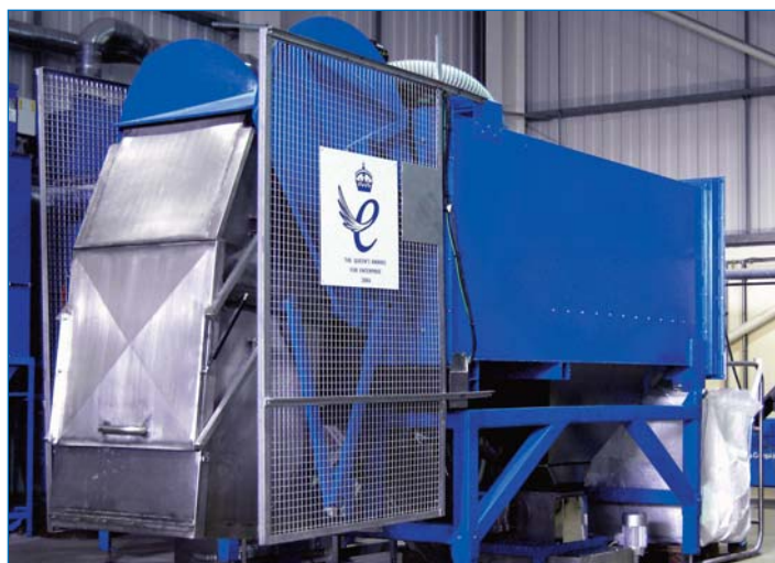
Załadunek maszyny recyklingowej odbywa się za pomocą urządzenia załadunkowego ze stali nierdzewnej o napędzie hydraulicznym, zamocowanego na przedzie maszyny, w którym można umieszczać beczki 210-litrowe lub odpady luzem. Fotografia przedstawia urządzenie pracujące w firmie Balcan.
