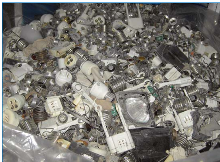
Przykłady rodzajów i stanu odpadów metalowych oraz odpadów z tworzyw sztucznych po oddzieleniu od szkła i opuszczeniu separatora.
