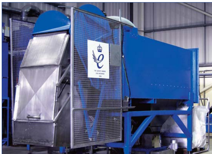
Le chargement du recycleur s'effectue au moyen d'un chargeur en acier inoxydable à commande hydraulique, monté à l'avant, qui accepte les fûts de 210 litres ou les débris en vrac. Cette photographie a été prise en cours d'exploitation chez Balcan.
